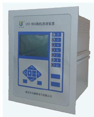
该装置实时显示系统时钟及 PT 开口三角电压 17HZ、25HZ、50HZ、150HZ 四种频率的电压分量，可以区分过电压、铁磁谐振及单相接地，并配置通信接口把各种故障信息传送至有关部门，适用于无人值守变电站。
